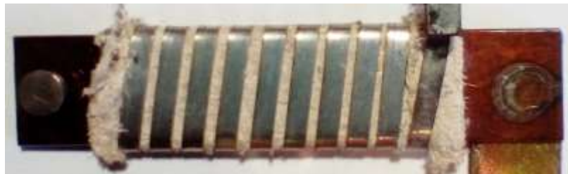
Figura 3.10 Lamela bimetalică din releul termic
