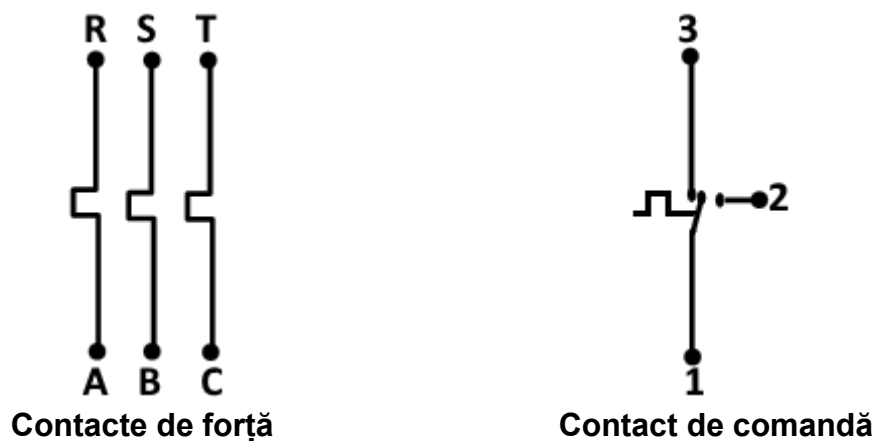
Figura 3.15 Simbolurile contactelor releelor termice
