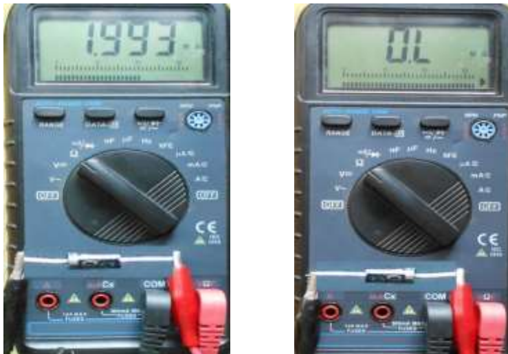
Figura 3.4 Măsurarea rezistenței joncțiunii diodei în ambele sensuri
