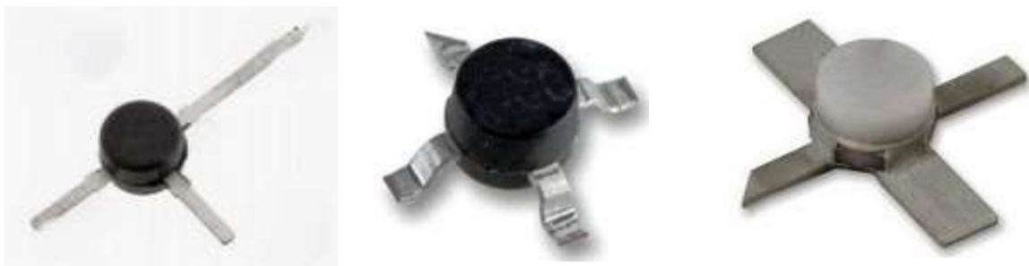
Figura 5.5 Capsule de tranzistoare de radio-frecvență
