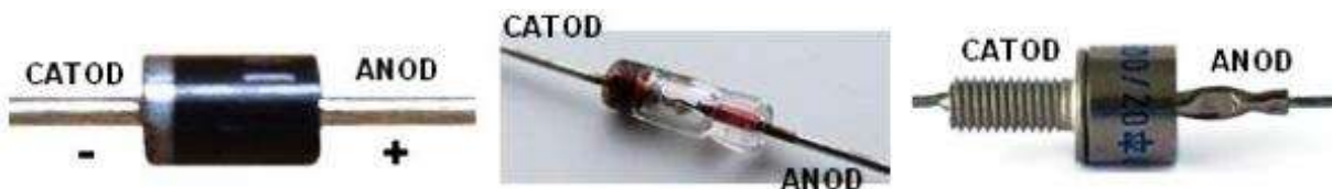
Figura 3.3 Identificarea terminalelor diodei în funcție de tipul capsulei
