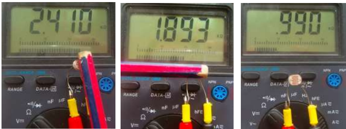
Figura 8.3 Comportarea fotorezistorului la modificarea intensității fluxului luminos
