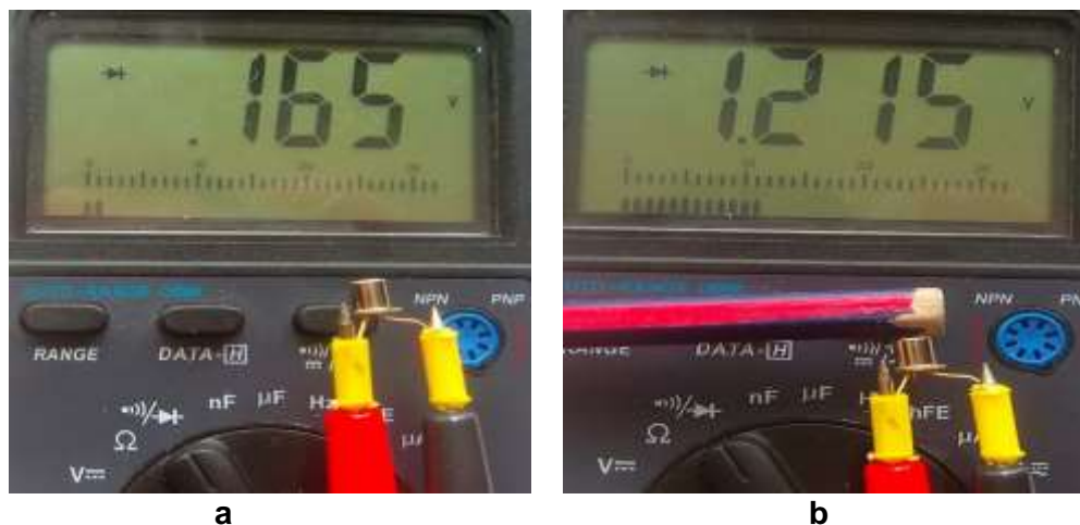
Figura 8.15 Identificarea terminalelor și verificarea fototranzistorului cu multimetrul
