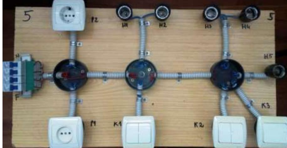
**Figura 4.4 Panolie demonstrativă cu instalație de iluminat și prize**
