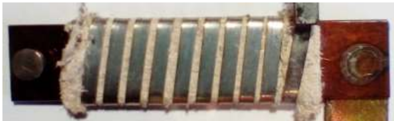
Figura 3.10 Lamela bimetalică din releul termic
