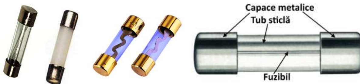
Figura 3.1 Siguranțe fuzibile în tub de sticlă
