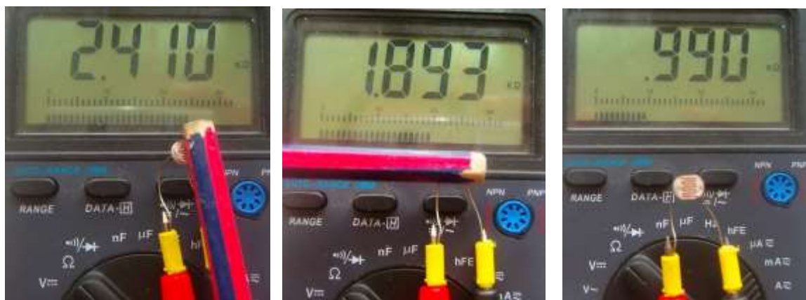
Figura 8.3 Comportarea fotorezistorului la modificarea intensității fluxului luminos
